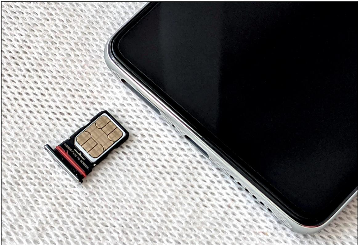
So legen Sie die SIM-Karte ein: Sie drücken mit dem beiliegenden Stechwerkzeug die Schublade durch das kleine Loch auf der Geräteunterseite heraus. Dann legen Sie die SIM-Karte mit den Beschriftung nach unten in das Fach mit der Beschriftung »SIM1«. Beim anschließenden Hineinschieben der Schublade ins Handy müssen Sie sehr vorsichtig sein, denn die SIM-Karte darf auf keinen Fall herausfallen oder sich verkannten.
