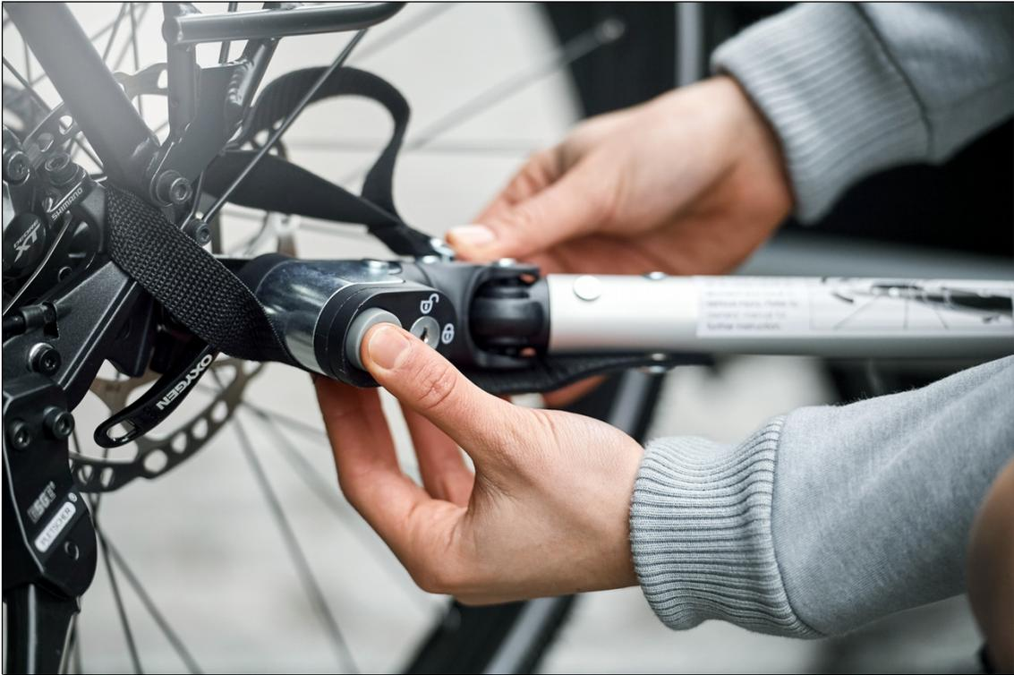
Mit einem Knopfdruck lässt sich die Verbindung zwischen Deichsel und Kupplung des Kinderanhängers »Kid Plus« von Croozler lösen. Der Hersteller nennt das System »Click & Crooz«. Foto: [www.pd-f.de](http://www.pd-f.de) / Paul Masukowitz
