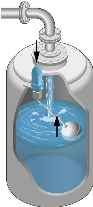
**Bild 2.3:** Mechanische Erfassung und Übertragung auf einen Aktuator (Füllstand)
