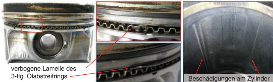
**Bild 3.7** Fehlerhafte Montage des dreiteiligen Ölabbstreifings und Folgeschäden
