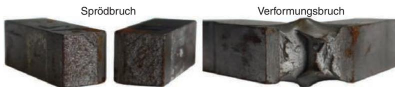
**Bild 3.14** Makroskopische Merkmale Sprödbbruch- und Verformungsbruchfläche [Bild: www.tec-science.com]
