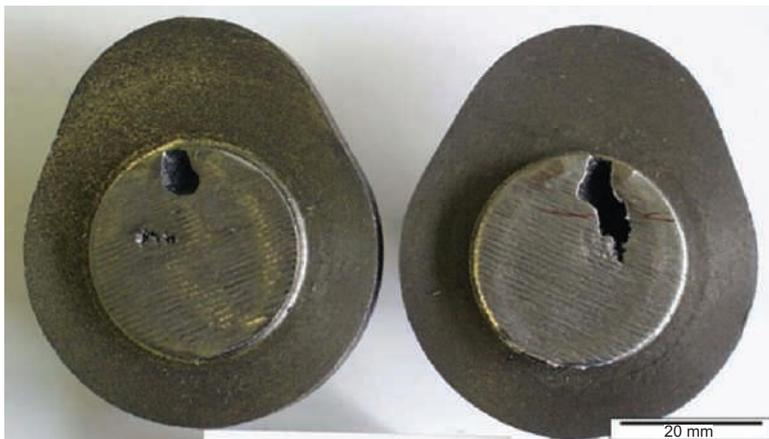
**Bild 3.1** Materialfehler: Lunker Nockenwelle [Bild: [www.giessereilexikon.com](http://www.giessereilexikon.com)]
