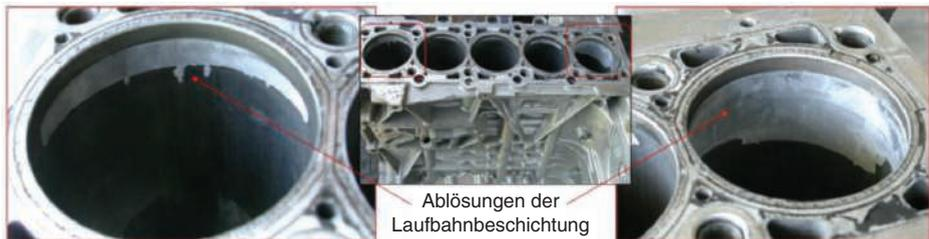
**Bild 3.2** Materialfehler: Abgelöste Zylinderlaufbahnbeschichtung [Bild: Wild-Motoren]
