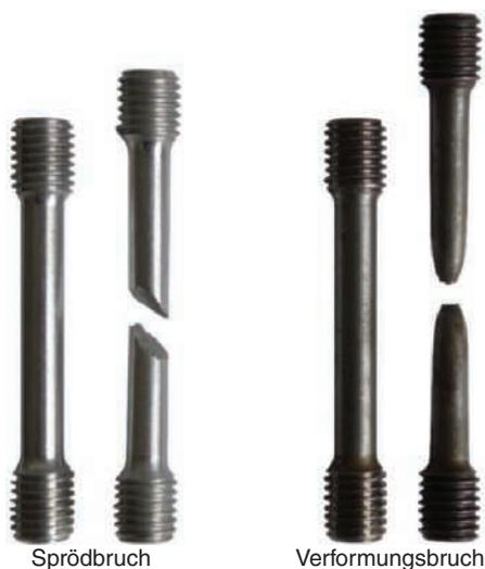
**Bild 3.13** Spröder und duktiler Gewaltbruch an Zugproben [Bild: [www.tec-science.com](http://www.tec-science.com)]
