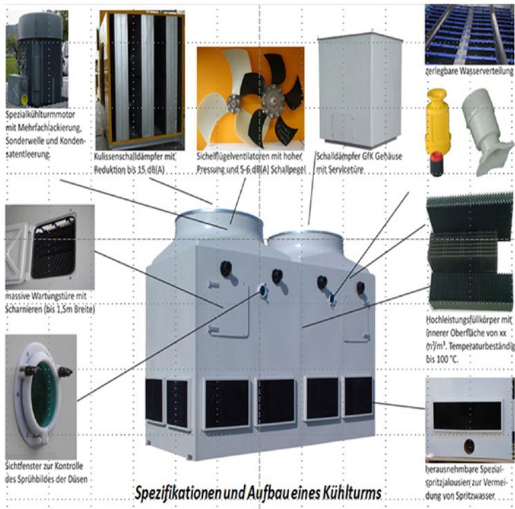
**Bild 3:** Merkmale und Spezifikationen für den Aufbau eines Verdunstungskühlturms (Quelle: Annen)
