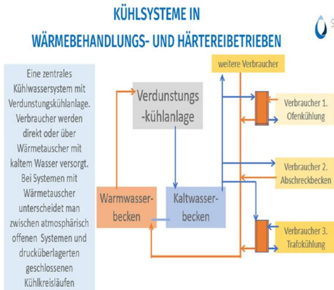
**Bild 5:** Fließbild von einer Verdunstungskühlanlage in einem Härtereibetrieb
