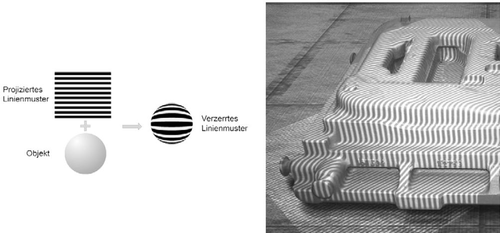
**Bild 2.11:** Projektion eines Linienmusters auf eine Kugeloberfläche (links) (Quelle: Fachhochschule Dortmund) und Anwendungsbeispiel (rechts) (Quelle: 3D Activation GmbH, Wiesbaden, Deutschland)
