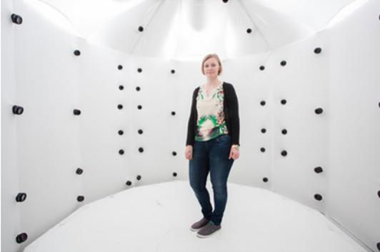
**Bild 2.10:** Scan-Raum mit 80 Spiegelreflexkameras, die gleichzeitig auslösen (Quelle: breeze media GmbH, Schorndorf, Deutschland)
