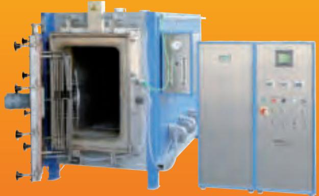
**Glühen, Löten, Tempern unter Schutzgas / Vakuum. Wärmebehandlung von Federn und Coils (Draht, Band), Herstellung von Metallschäumen. Schutzgas- /Vakuumkammeröfen mit Gasumwälzung bis 1200 °C, 2000 l mit hitzebeständiger gasdichter Muffel.**
