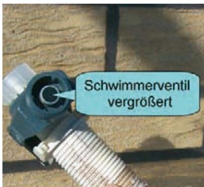
Jetzt können Sie den demontierten Schwimmer – und vor allem sein Ventil – nach Bedarf von Kalk und Schmutz befreien.
