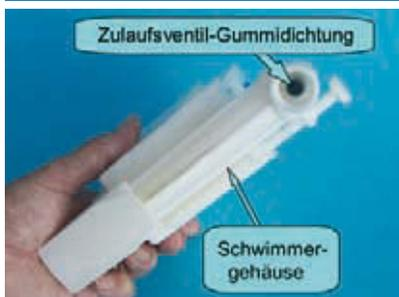
Die Gummidichtung des Zulaufsventils muss selbstverständlich auch gut gereinigt werden. Diese Dichtung wird von dem Schwimmer jeweils nur sanft ange-drückt – im Gegensatz zu Dichtungen an Wasserhähnen, die oft kräftig mit der Hand zuge-dreht werden. Daher ist eine Erneuerung dieser Dichtung unter normalen Umständen nicht erforderlich. Eine
