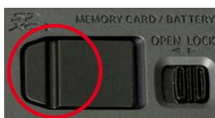
◀ Die Gummiabdeckung im Deckel des Akkufachs muss bei Verwendung des Kopplers DMW-DCC11 abgenommen werden, da hier das Verbindungskabel eingesteckt wird.
