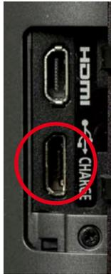
◀ Der Micro-USB-Anschluss für das mitgelieferte Ladekabel befindet sich hinter der seitlichen Klappe im Handgriff. Bitte setzen Sie das Kabel vorsichtig an und verkanten Sie es nicht! Die kleinen Stecker und Buchsen sind sehr empfindlich.
