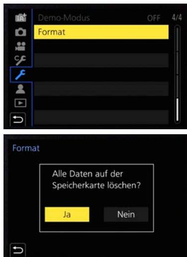
▲ Im Menü **Setup 4/4** wird mit dem Befehl **Format** die Speicherkarte formatiert. Bestätigen Sie die Abfrage mit **Ja** (MENU/SET-Taste).
