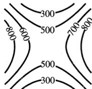
**Figura 1.44:** Passagem entre duas montanhas
