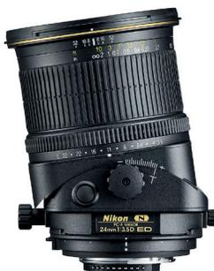
Los objetivos descentrables pueden desplazarse en altura (descentrar) o variar el plano de enfoque (bascular). Es ésta última opción la que se utiliza en fotografía de producto en estudio, pues nos permite modificar el plano de enfoque que, con frecuencia, no es paralelo al plano del sensor.
