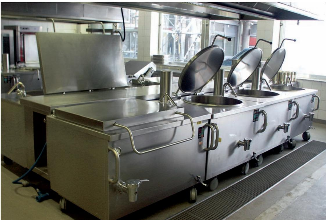
**Bild 2.4** Krankenhausküche mit großvolumigen Gargeräten in mobiler Ausführung
