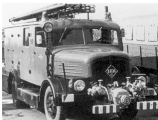
LF 15 H3A mit einem Aufbau des VEB FLG Jöhstadt. Das LF verfügt noch über die für die damalige Zeit typischen Gerätekästen zwischen den Kotflügeln. Rechts daneben ein LKW Horch H3 im Dienst der Feuerwehr.
