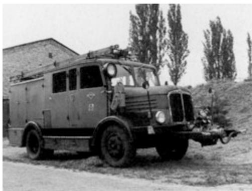
LF 15 auf H3A mit Vorbaupumpe, aufgebaut 1951 in Luckenwalde für die Feuerwehr im Kupfer- und Messingwerk Hettstedt.
