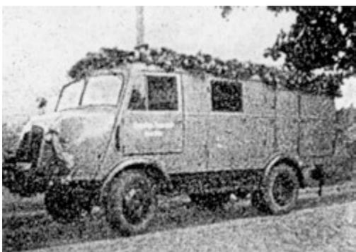
**Horch H3 Löschgruppenfahrzeug der FF Neu-Zittau, 1957 aus einem H3-Pritschen-LKW in Eigenleistung aufgebaut.**
