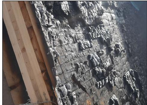
**Bild 9.7** Wandbauteil, das mit einer Brandbeanspruchung im Versuch analog einer vollausgestatteten Wohnung über mehr als 90 Minuten beansprucht wurde. Die Holzkohleschicht verzögert das Fortbrennen in die Tiefe des Bauteils.
