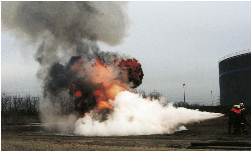
**Bild 7.5** Löschpulvereinsatz bei einem Brand der Brandklasse B
