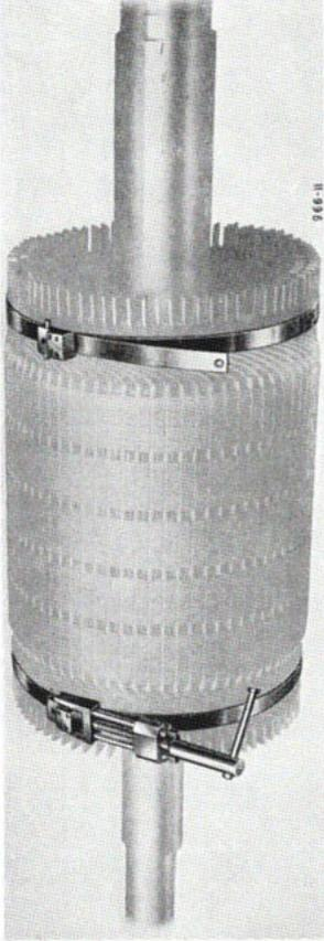
Abb. 39. Vorbereitung einer Stabwicklung für das Aufziehen der Bandagen mit Hilfe von Spannbandern (Werkbild: Micafil, Zürich)
