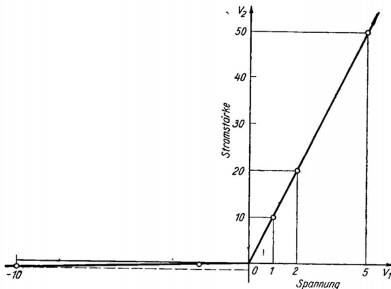
Abb. 3.1. Messungen an einer Diode
