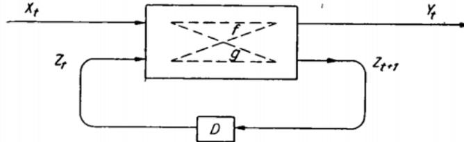
Abb. 5.2. Schema eines Automatenmodells von HUFFMAN
