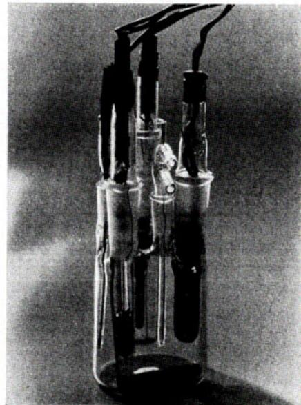
Abbildung C. Meßgefäß mit Thermostatisierung
