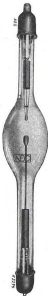
Fig. 3. Höchstleistungs-Röntgenröhre der AEG für Tiefentherapie. Leistung 1—2KW, Anodenspannung bis 230 000 V, Anode als Wolfram-Antikathode ausgebildet.
