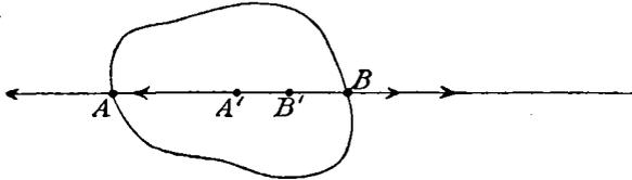
Fig. 13. Verlegung des Angriffspunktes.
