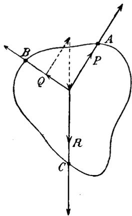
Fig. 14. Gleichgewicht am starren Körper.
