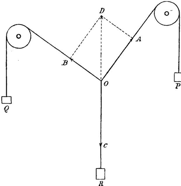
Fig. 11. Kräfteparallelogramm.
