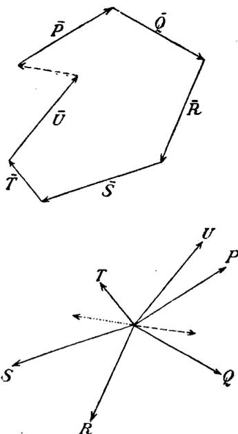
Fig. 12. Vektorenaddition.
