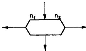
Der Kasten enthält *einen* Eingangspfeil und *mindestens zwei* Ausgangslinien in beliebiger Lage. Der Kasten selbst enthält im allgemeinen die Bedingung, die den Durchlauf durch die Verzweigung bestimmt. Die Zweige werden dazu mit bestimmten Texten gekennzeichnet, die in eindeutigen Zusammenhang mit den Bedingungen stehen.
