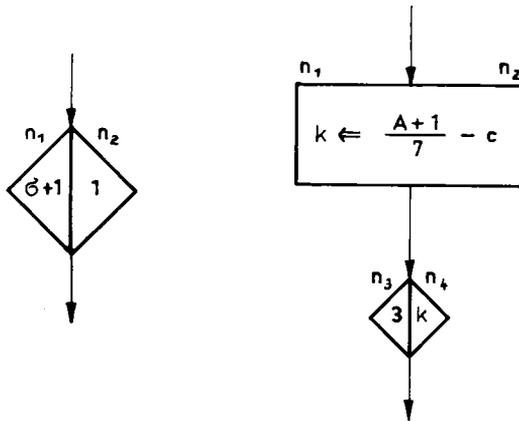
Auf diese Weise gestellte *Verzweigungen* werden genauso dargestellt wie die Bedingungsverzweigungen. Nur wird diesmal innerhalb des Kastens anstelle der Bedingung das Stellsymbol mit dem Verzweigungsnamen eingetragen. Die Namen der Ausgänge werden jeweils an die Ausgangslinien geschrieben. Eine zum rechts oben gezeichneten Stellsymbol gehörende Verzweigung kann also folgendermaßen aussehen:
