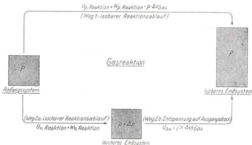
Abb. 2. Zusammenhang zwischen isobarer und isochorer Reaktionswärme bei Gasreaktionen
