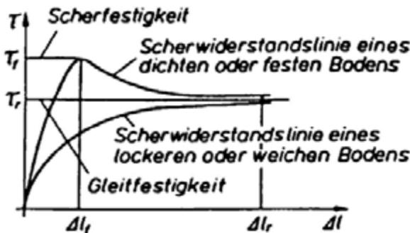
Abb. 23 Scherwiderstandsdiagramm (aus DIN 18137, T1)
