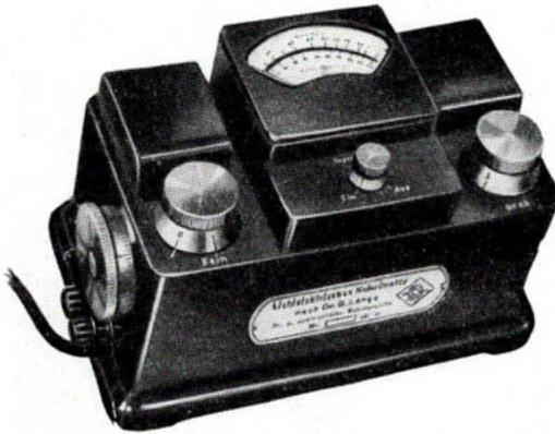
Abb. 5. Lichtelektrisches Kolorimeter nach Dr. LANGE (Modell IV) (Neuerdings auch mit fester Eichung)
