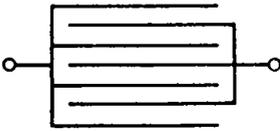
Abb. 59 Schnitt durch einen Blockkondensator (schematisch)
