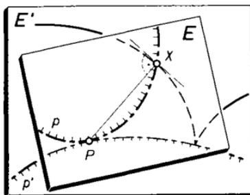
Fig. 3. Die rollenden Polkurven, Bahn eines Punktes der Gangpolbahn
