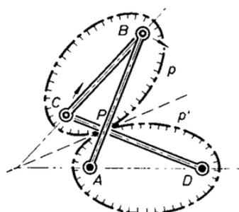
Fig. 11. Gleichläufiges Zwillingsgetriebe
