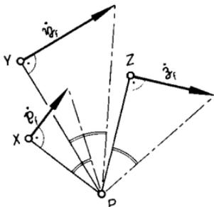
Fig. 2. Verteilung der Führungsgeschwindigkeiten
