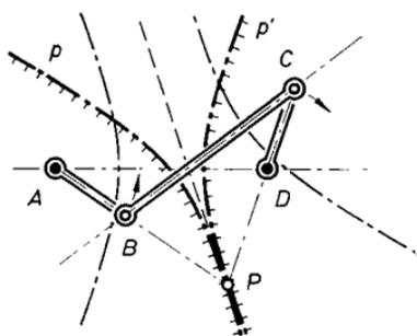
Fig. 12. Gegenläufiges Zwillingsgetriebe
