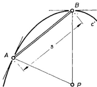
Fig. 6. Bewegung einer Kurvensehne fester Länge
