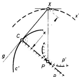
Fig. 7. Gleiten einer Kurventangente, Krümmungskreisconstruction
