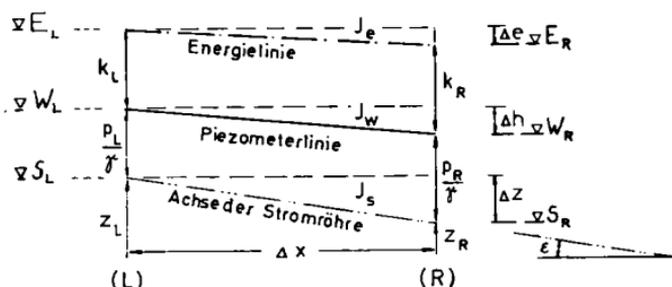
Fig. 1-5 Stationäre Fließbewegung
