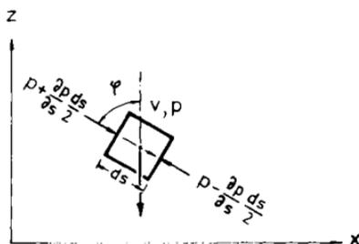
Fig. 1-3 Flüssigkeitselement und die in Stromlinienrichtung wirkenden Druckkräfte
