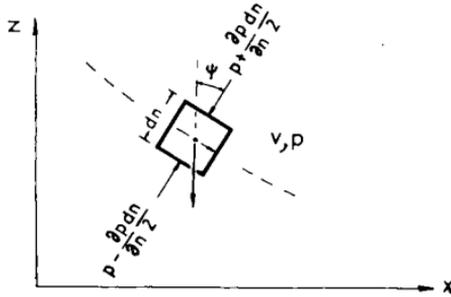
Fig. 1-4 Flüssigkeitselement und die quer zur Stromlinienrichtung wirkenden Druckkräfte
