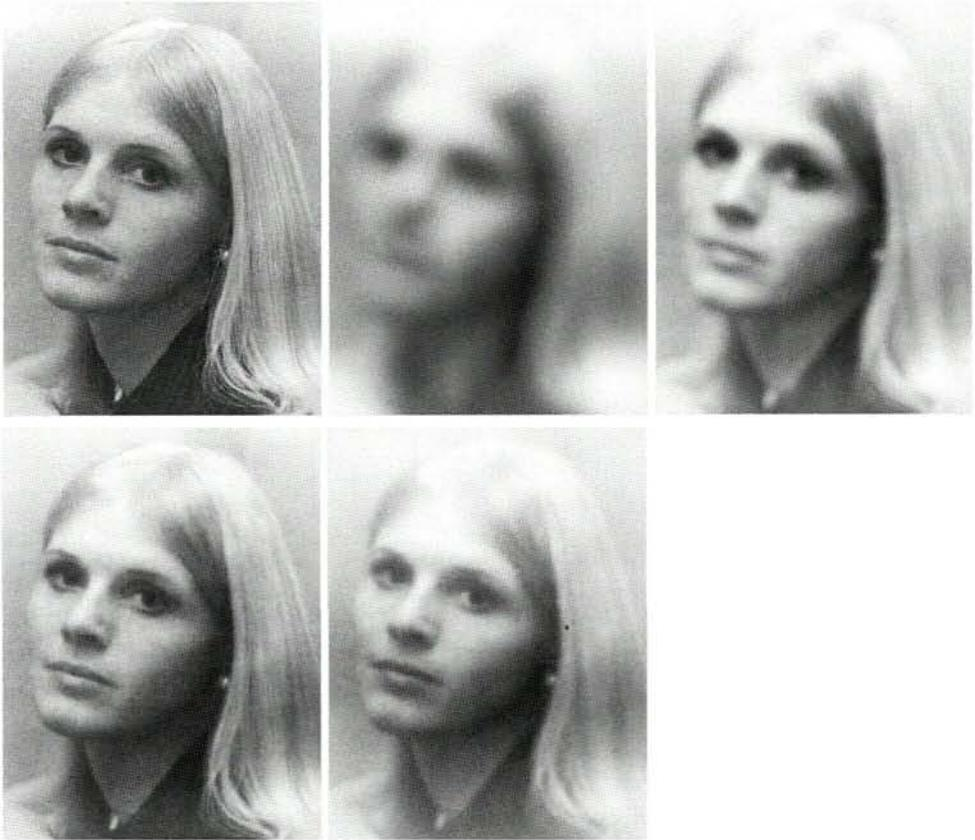
**Abb. 1.11** „Abbildung“ mit einer Lochkamera bei Verkleinern des Lochdurchmessers  $d$ . Abstand Loch–Film 100 mm. Die geringere Lichtintensität auf dem Film beim Verkleinern von  $d$  wurde durch entsprechende Verlängerung der Belichtung kompensiert. Oben links: Originalbild mit Photoobjektiv. Oben Mitte:  $d = 3,0$  mm. Oben rechts:  $d = 1,0$  mm. Unten links:  $d = 0,3$  mm. Unten Mitte:  $d = 0,15$  mm.
