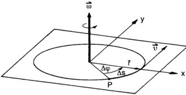
Abb. 1.7 Winkelgeschwindigkeit  $\vec{\omega}$  und Bahngeschwindigkeit  $\vec{v}$ .
