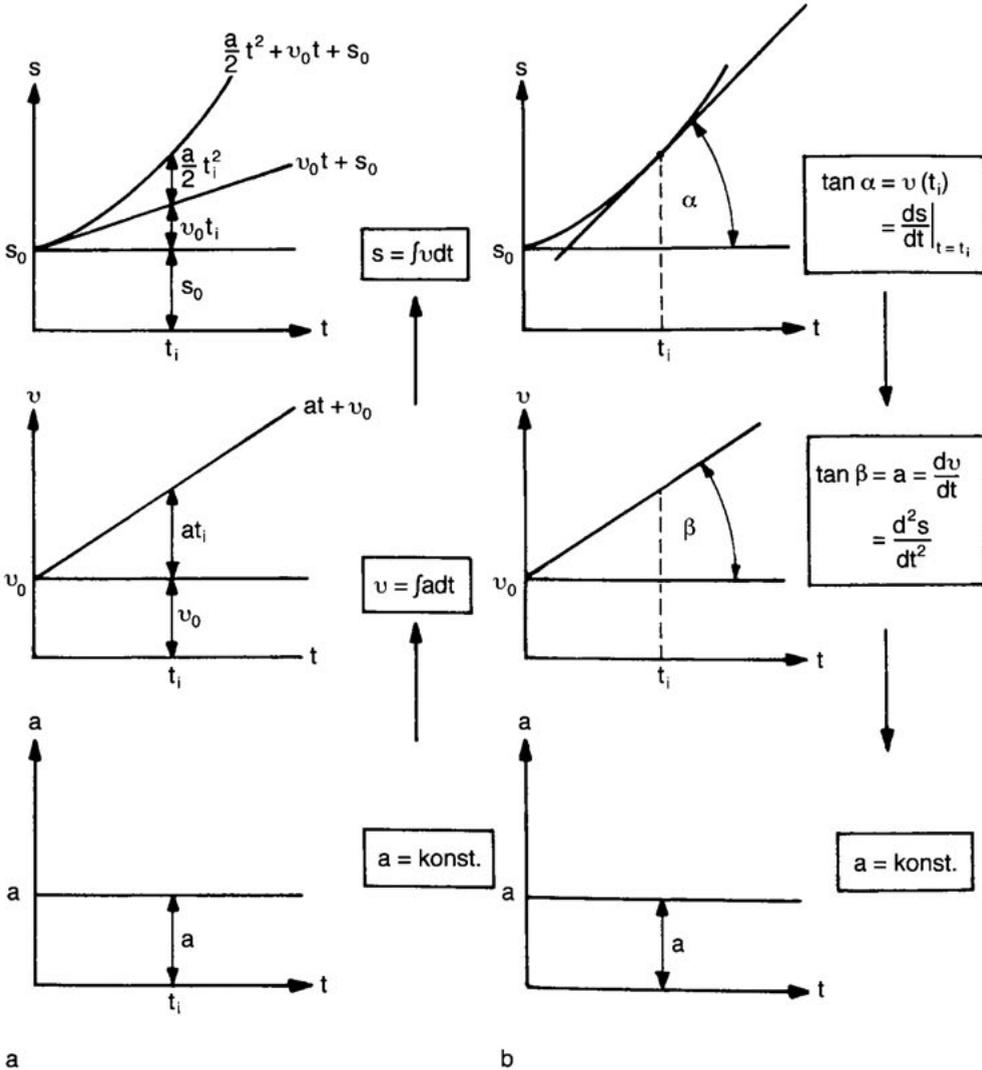
**Abb. 1.9** (a) Weg-Zeit-Diagramm und Geschwindigkeits-Zeit-Diagramm, wie sie durch Integration aus dem Beschleunigungs-Zeit-Diagramm folgen. (b) Geschwindigkeits-Zeit-Diagramm und Beschleunigungs-Zeit-Diagramm, wie sie durch Differentiation aus dem Weg-Zeit-Diagramm folgen.
