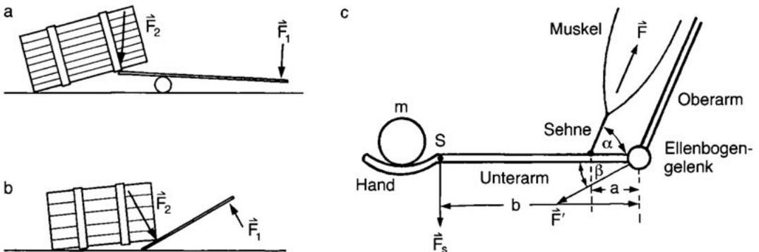
Abb. 2.5 Hebel: (a) zweiarmig, (b) einarmig, (c) einarmige Hebelwirkung des menschlichen Arms (S: Schwerpunkt des aus dem Unterarm und der Masse  $m$  bestehenden Systems).
