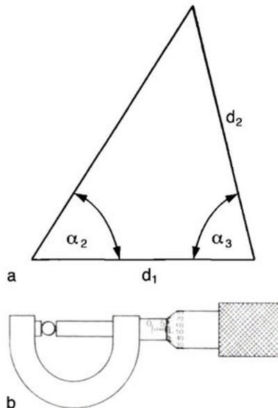
**Abb. 1.1** Triangulation zur Bestimmung von  $d_2$  aus den gemessenen Größen  $d_1$ ,  $\alpha_2$  und  $\alpha_3$  (a); Schraublehre (b).
