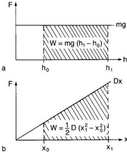
Abb. 3.1 Kraft-Weg-Diagramm. (a) Hubarbeit, (b) Spannarbeit einer Feder.
