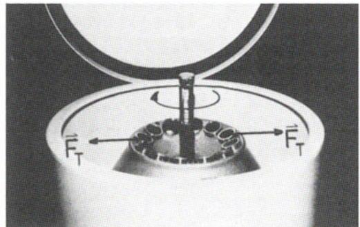
Abb. 2.1 Zentrifuge (zu sehen sind das Schutzmantelgefäß mit Deckel, der Rotor und die schräg eingesetzten Zentrifugenröhrchen, in die die Suspension eingefüllt wird).
