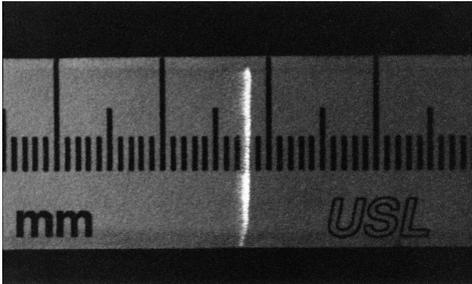
Ein einzelner kollimierter Laserpuls, der über die Oberfläche eines Lineals streicht. Der ultrakurze Lichtblitz entspricht einem Abschnitt einer ebenen Welle, der nur  $300 \times 10^{-15}$  s andauerte und lediglich einen Bruchteil eines Millimeters lang war. (Mit frdl. Genehmigung von J. Valdmánis und N. H. Abramson.)
