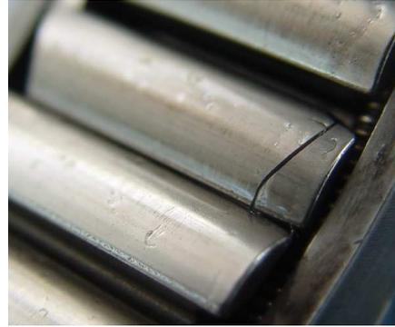
Fig. 15 Breakage of sprag
