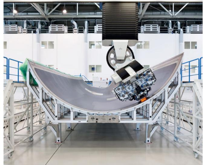
Automatisierte Herstellung einer A350-Seitenschale bei Premium Aerotec im Automated Fiber Placement
