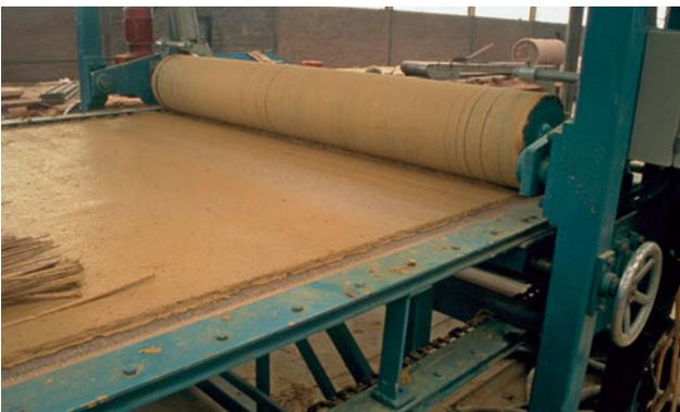
Abb. 25 Lehmplattenfertigung 1996 (Claytec®)
