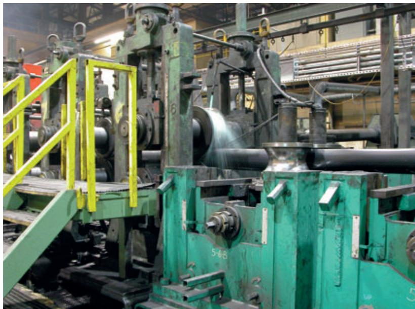
Links: Zur Herstellung von Hohlprofilquerschnitten wird Stahlblech von der Rolle eingesetzt. Die Breite des Bleches bestimmt den Umfang der Röhre.
