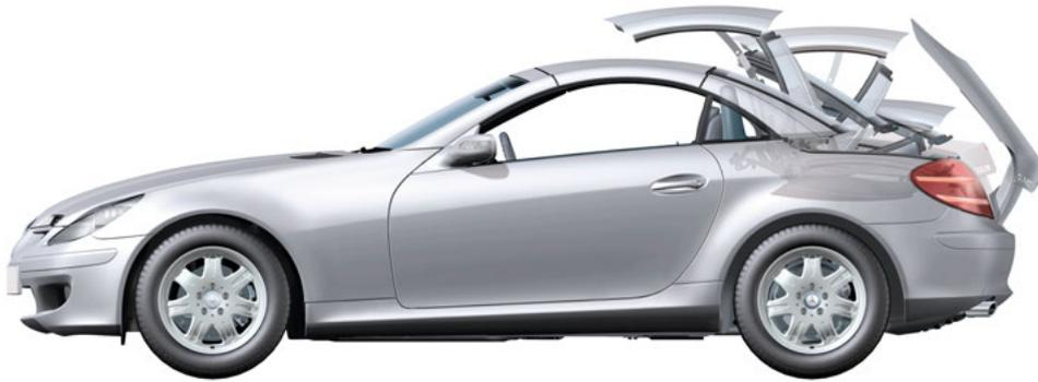
Mercedes SLK-Klasse, 2004: Das weiterentwickelte Variodach öffnet und schließt sich innerhalb von 22 Sekunden.
