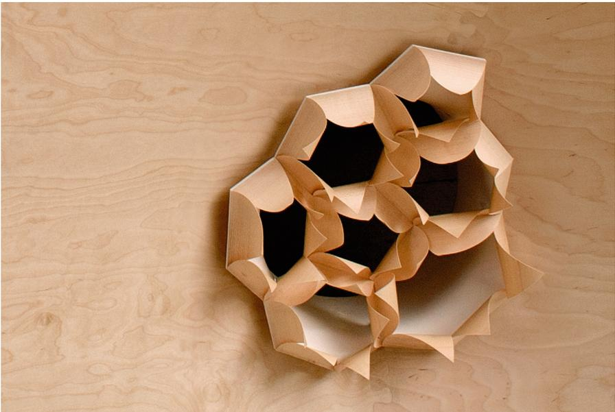
**Abbildung 16:** Sperrholz mit reaktiver Apparatur aus Furnierverbund auf Kunststoffstruktur, Stuttgart, Universität, Institute for Computational Design (ICD)
