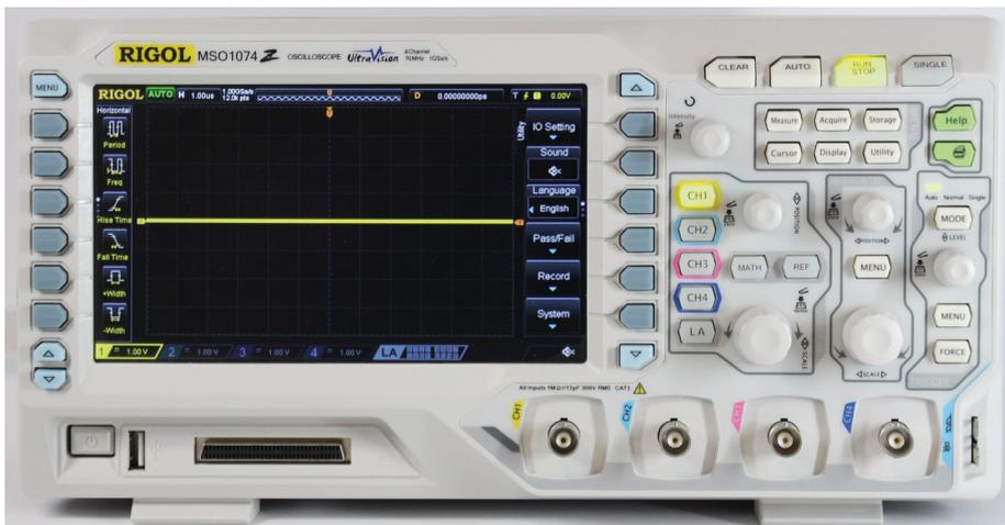
*Bild 1.2 Bei einem MSO ist meist unter dem Bildschirm die Anschlussleiste des Logikanalysators zu sehen*
