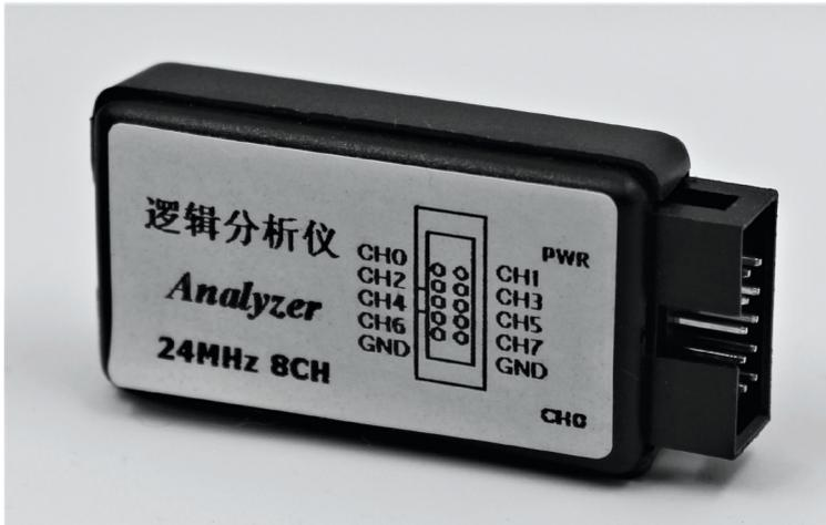
Bild 1.6 Ein günstiger 8-Kanal Logikanalysator für den Einstieg in die Protokollanalyse
