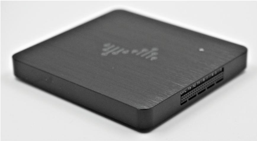
*Bild 1.3 Ein DSLogic Plus Logikanalysator – Modern und leistungsfähig*
