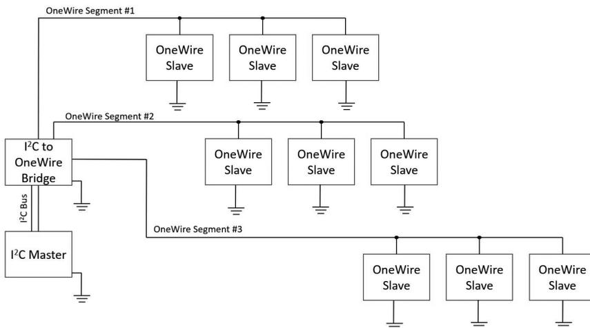
Der Bridge-Chip dient als Umschalter zwischen den OneWire-Zweigen.
