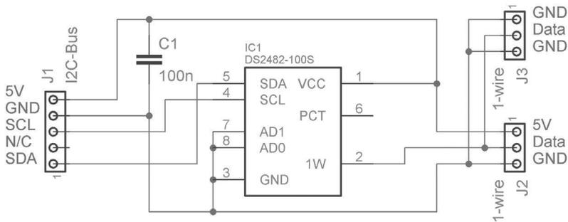
Mit dem Ausgang PCT kann man einen externen MOSFET-Transistor ansteuern und damit die Leistungskraft des 1-Wire Buses stärken.
