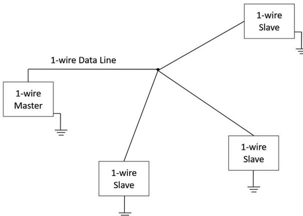
Laut Hersteller ist die Stern-Topologie die am meisten fehleranfällige und wird deswegen nicht wirklich empfohlen. Genauso nicht empfehlenswert ist es, verschiedene Topologien zu mischen. Mit einer Ausnahme!
