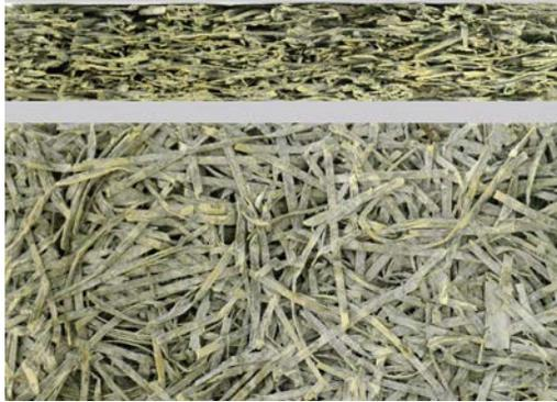
**Abb. 1.22:** Holzwohle-Leichtbauplatte (Ansicht und Schnitt)
