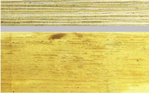
**Abb. 1.16:** Furnierschichtholz (Ansicht und Schnitt)
