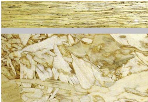
**Abb. 1.18:** Langspanholz (Ansicht und Schnitt)
