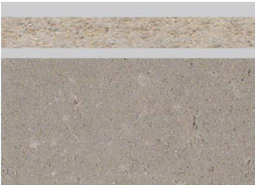
**Abb. 1.21:** Zementgebundene Spanplatte (Ansicht und Schnitt)
