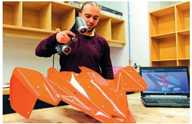
**Bild 3:** Oberflächenmesssystem Creaform HandyScan (rechts) (Quelle: Creaform).
