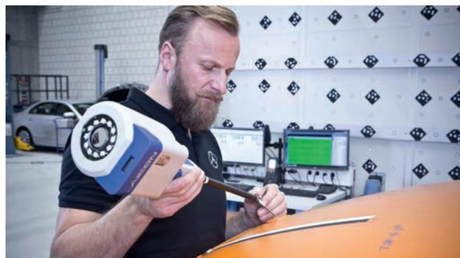
**Bild 1:** Online-Messsystem ProCam von Hexagon
