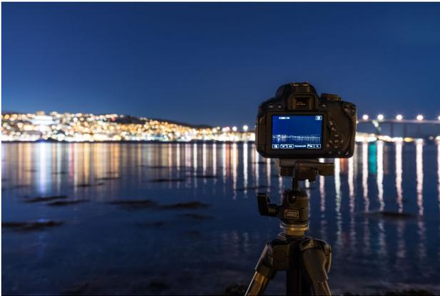
↑ Alles bereit für die Langzeitbelichtung: Verschlusszeit, Blende und ISO-Wert sind an die Lichtverhältnisse der Blauen Stunde angepasst, das Stativ steht sicher, das Objektiv ist manuell fokussiert.
