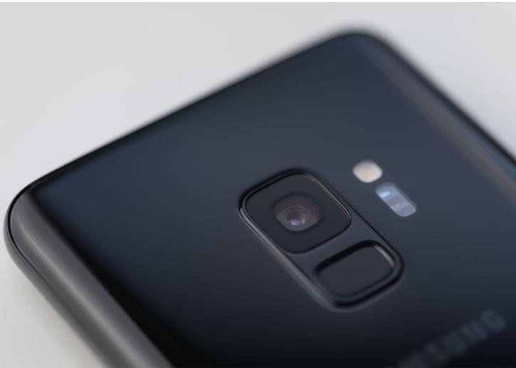
↑ Die Kamera des Samsung Galaxy S9 war die erste mit variabler Blende ( $f1,5$  und  $f2,5$ ) in einem Smartphone. Heute sind schon drei oder vier Linsen möglich. Vergleichbar mit den Blendenstufen eines DSLR-Objektivs sind die Werte jedoch noch lange nicht.
