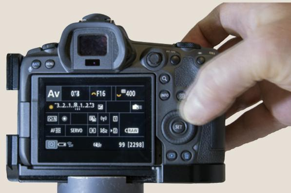
⤴ Eine Reihe von Kameramodellen lassen sich so konfigurieren, dass die Belichtungskorrektur ohne vorherigen Tastendruck direkt über ein Einstellrad vorgenommen werden kann. Das geht deutlich schneller.
