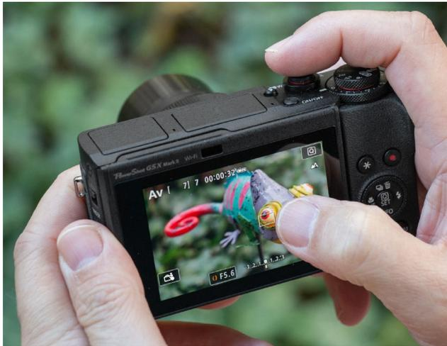
▲ Bei Kompaktkameras mit Touchscreen und kleinem AF-Feld kann die Schärfe schnell und präzise auf das gewünschte Detail gelegt werden, hier gezeigt an einer Canon PowerShot G5 X Mark II.
