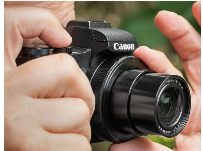
▲ Wenn das Objektiv ein Gewinde hat, hier zu sehen an der Canon G1 X Mark III, können die Makrofähigkeiten der Kompaktkamera mit einer Nahvorsatzlinse erweitert werden.
