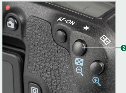
^ Oben: Belichtungsspeicherung mit der AEL-Taste ① bei Sony. Unten: AE-Speicherung mit der Sterntaste ② bei Canon
