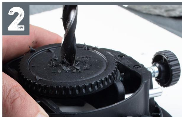
**Das Loch bohren** Spannen Sie den Kameradeckel irgendwo ein, in einen Schraubstock, wenn Sie einen haben. Ich habe einfach eine Blitzklemme verwendet, die ich gerade zur Hand hatte. Setzen Sie eine eher dicke (8–10 mm zum Beispiel) Bohrspitze auf den Bohrer, am
