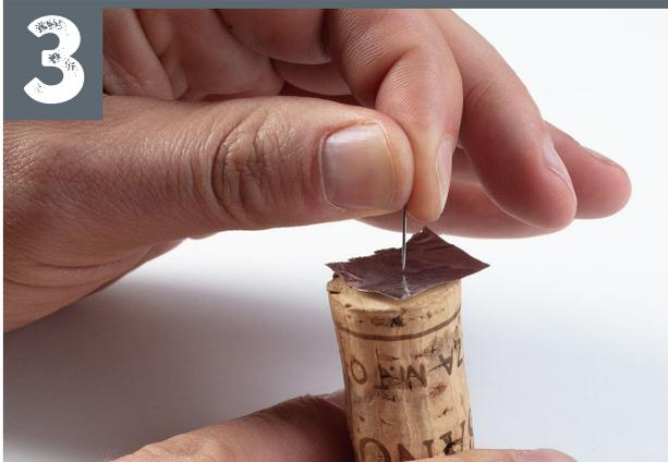
**Alufolie und Nadel für das Aufnahme Loch** Schneiden Sie sich ein Stück Alufolie zurecht, größer als das Loch im Deckel, aber etwas kleiner als der Innendurchmesser des Deckels. Stechen Sie mit der Nadel ein kleines Loch ungefähr in die Mitte der Alufolie, die genaue Justierung kommt gleich noch. Das geht am besten, wenn Sie die Alufolie auf einen Weinkorken oder etwas Ähnliches legen, so fransen die Ränder des kleinen Lochs nicht so aus.
