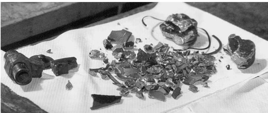
Bild 1.2 Totalschaden eines Motors als Folge eines Kolbenfressers
