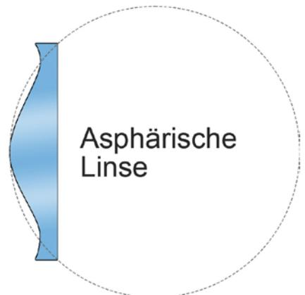
▲ Eine asphärische Linse ist eine Linse mit mindestens einer von der Kugel- oder planen Form abweichenden brechenden Oberfläche.
