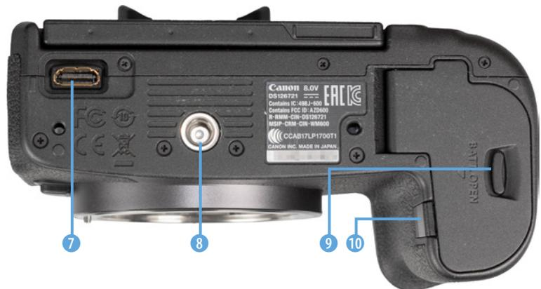
Das **Akkufach** 9 füllt den Handgriff des Kameragehäuses aus. Es besitzt eine kleine **DC-Kuppler-Kabelöffnung** 10, die benötigt wird, um das Kabel des optionalen DC-Kupplers **DR-E6** hindurch zu leiten. Der DC-Kuppler zusammen mit dem Netzadapter **AC-E6N** erlaubt das Fotografieren mit Strom aus der Steckdose.
