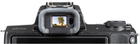
Damit Sie das Sucherbild immer sofort sehen können, wenn Sie sich mit dem Auge dem Sucherkasten nähern, schaltet der **Augensensor** den Sucher automatisch ein und den Monitor gleichzeitig aus. Das bedeutet aber auch, dass sich der Monitor abschaltet, wenn Sie mit der Hand oder einem Gegenstand vor den Sucher kommen.
