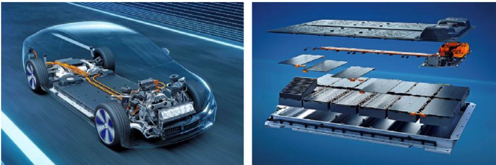
Bild 1.15: links: Fahrzeugaufbau mit flacher Batterie im Boden, rechts: Modularer Aufbau der Batterie (Quelle: Daimler Pressefoto und Mercedes-Benz Cars, 2021)
