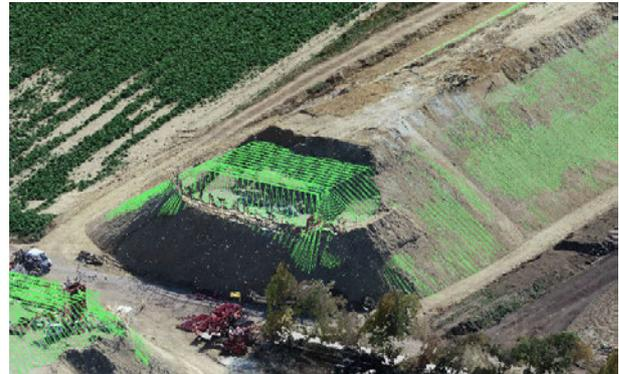
Abbildung 2: Maschinensteuerungsdaten Ausführung mit Punktwolke
