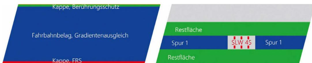
Abb. 7: Ausbaulasten (links) und maßgebende Verkehrslaststellung (rechts), Grafik: H+P Ingenieure
