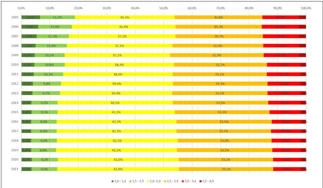
Bild 13: Zustandsnotenverteilung für Brücken an Bundesfernstraßen im Jahresvergleich anteilig nach Brückenfläche
